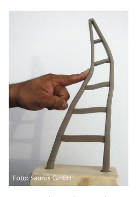
Der Fin Ray biegt sich stets in die Richtung, aus der der Druck kommt.
